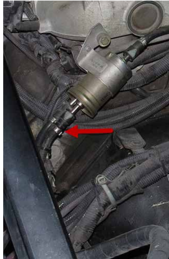
Photo 3. Image de la bague en acier sertie tenant en place un raccord sur un autre convoyeur à bagages identique non endommagé
