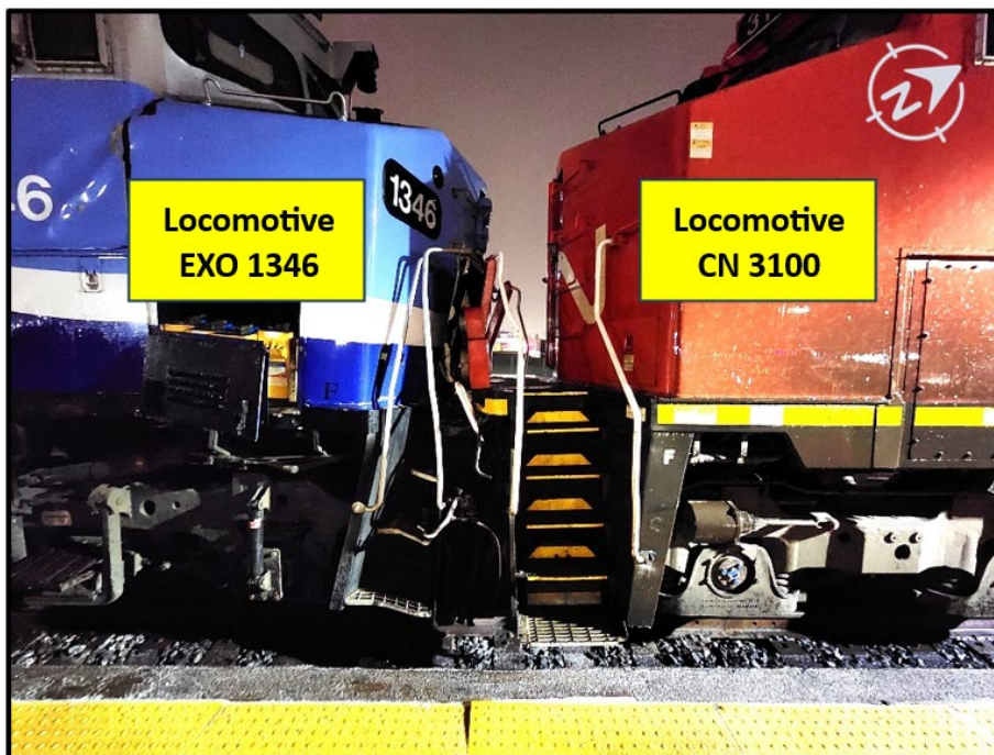
Figure 3. Dommages subis par les parties avant des locomotives EXO 1346 et CN 3100 (Source : BST)
