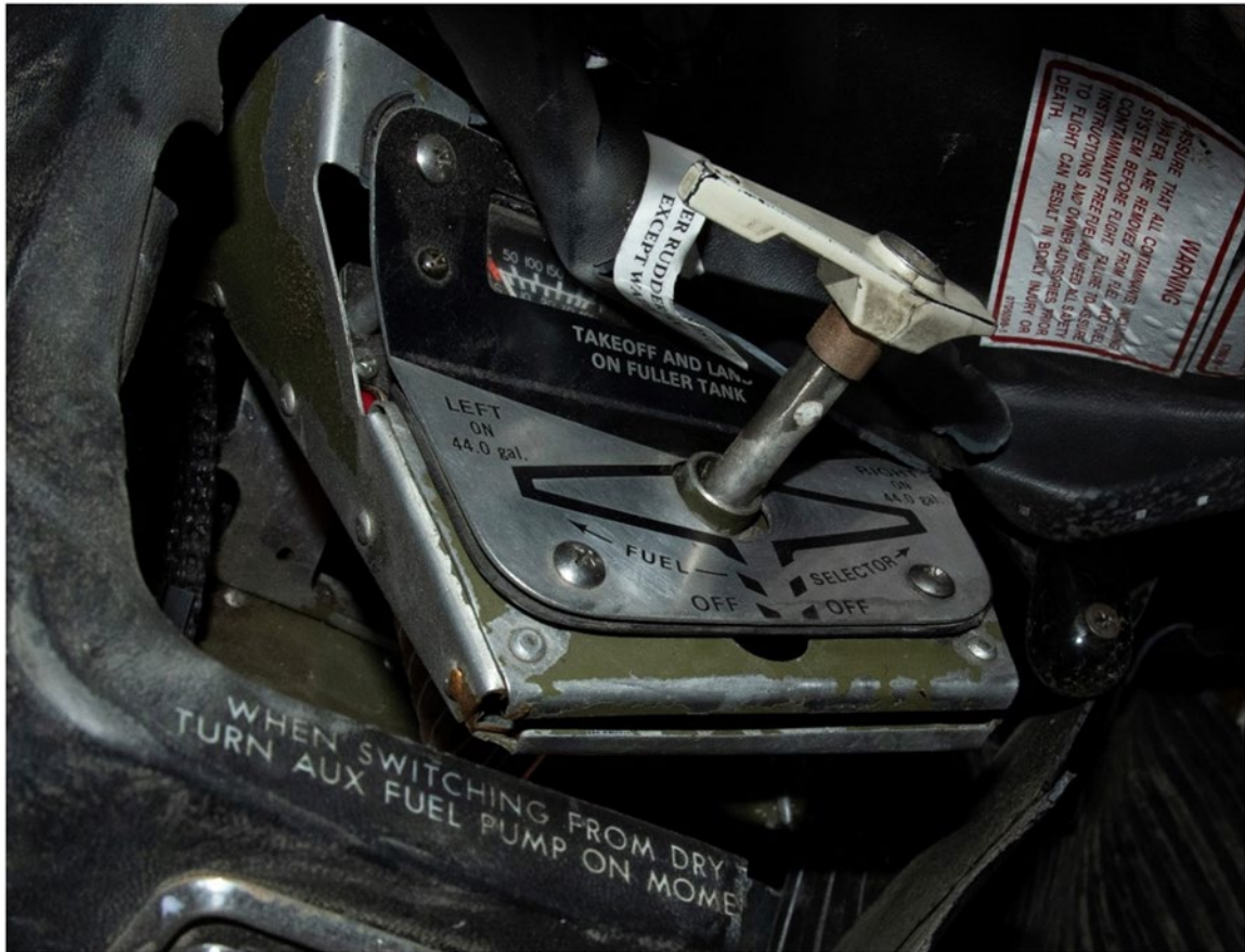
Figure 4. Poignée du sélecteur de carburant de l'aéronef de l'événement à l'étude, retrouvée en position LEFT ON après l'événement (Source : BST)
