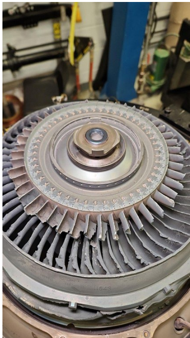
Figure 3. Premier étage de la turbine de puissance de l'aéronef à l'étude, une fois retiré du moteur, présentant des aubes brisées (Source : BST)
