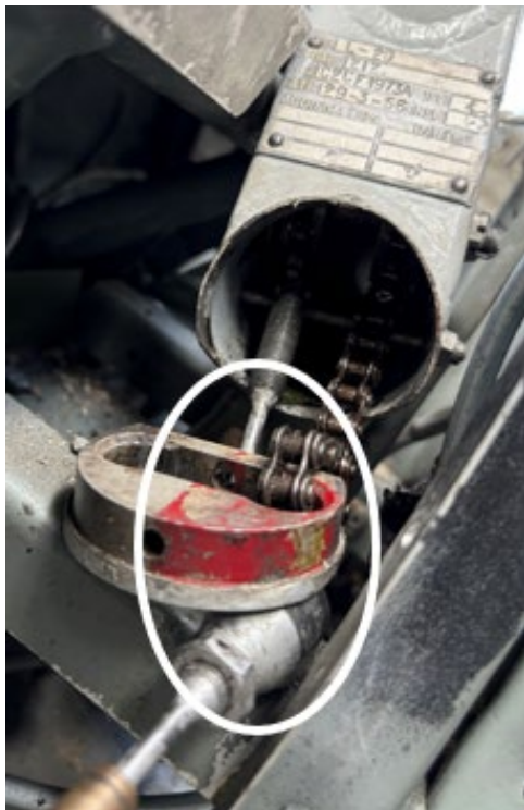
Figure 2. Peinture rouge sur la face intérieure du capuchon au bas de la colonne de contrôle (Source : tierce partie avec permission, et avec annotations du BST)
