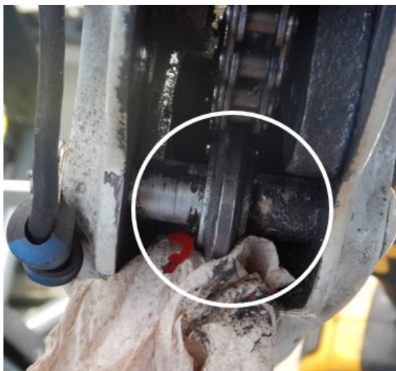
Figure 3. Reste de peinture rouge sur le guide de la chaîne au point de pivot de la colonne de contrôle une fois la graisse essuyée (Source : BST)
